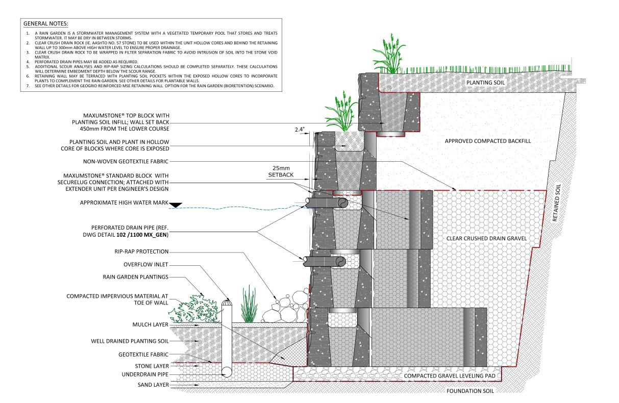
**GRAVITY-BIORETENTION POND DETAILS**
